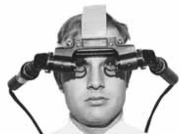
Le premier casque de réalité virtuel par Ivan Sutherland et Bob Sproull en 1967 Source : A Critical History of Computer Graphics and Animation Section 17: Virtual Reality
